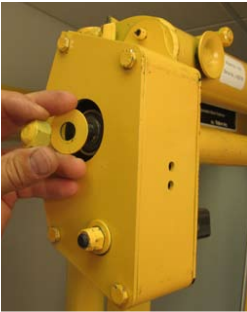
21) Install 1/2" washer and cap nut.
